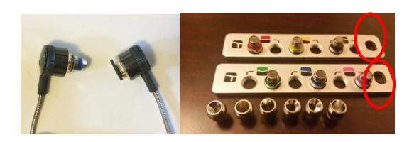
本体のキャップを外し、TorqueValve<sup>™</sup>を t096z の本体に装着し、ゆっくりと止まるまで 回して下さい。プレート端にある穴は TorqueValve<sup>™</sup>を閉めるたり、緩めたりするため のレンチの役割をします。指で回せば簡単にプレートからノズルは外れます。落として 失くさぬようにご注意願います。
